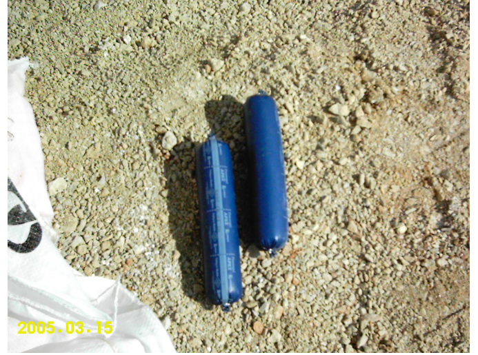
Şekil 15. Delik başlarına dağıtılan ANFO ve yemleme (Powergel Magnum 50*225mm)
