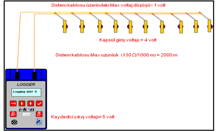
Şekil 3. Kaydedici'nin akım kaçağı kontrol şeması (3)
