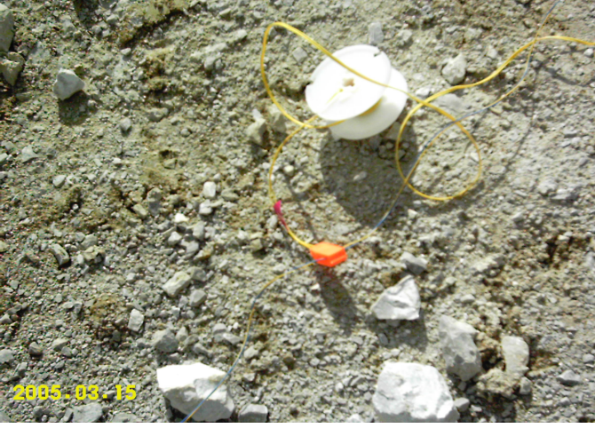
Şekil 18. Bağlantısı yapılmış gecikme süresi ayarlanmış bir patlatma deliği
