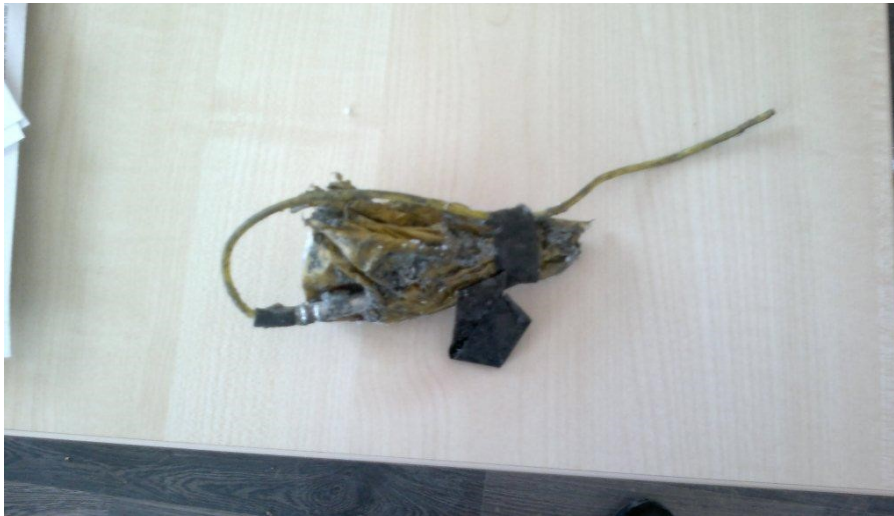
Şekil 7. Kapsüle duyarlı patlamamış emülsiyon patlayıcının kalıntıları
