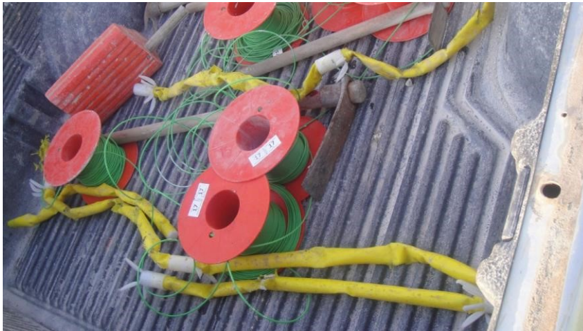
Şekil 8. Son kesme deliklerinde kullanılan özel patlayıcılar
