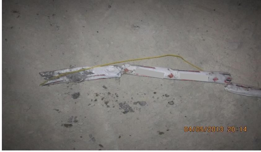
Şekil 5. Kapsül patlamasına rağmen patlamamış kapsüle duyarlı emülsiyon patlayıcı
